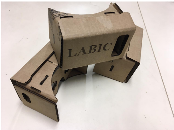
Imagem 4 - Google Cardboards desenvolvidos em cortadora CNC laser.
