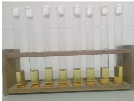
Figura 9 - Separação das fases após adição do desemulsificante natural
