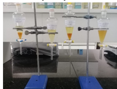
Figura 5 - Emulsão formada após reação de transesterificação utilizando o etanol no óleo refinado e no óleo de fritura no segundo e no quarto funil de decantação da esquerda para direita
