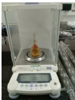
Figura 1 - Medida de massa do óleo de fritura usando balança analítica pelo método do picnômetro
