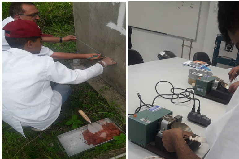
Figura 6 - (a) aplicação da argamassa (b) ensaio de Índice de plasticidade
