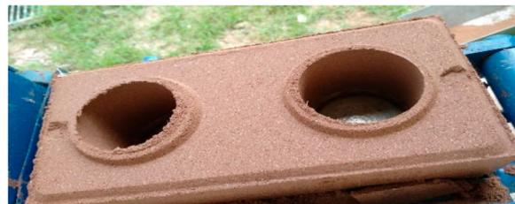
Figura 1 – Tijolo de solo – cimento prensado
