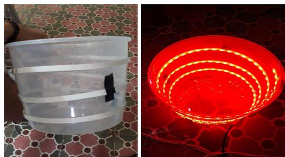
**Figura 1** - Fermentador fotoestimulado com LED vermelho.
