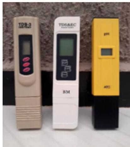
**Figura 2:** medidores digitais (TDS, TDS/EC e pH).
