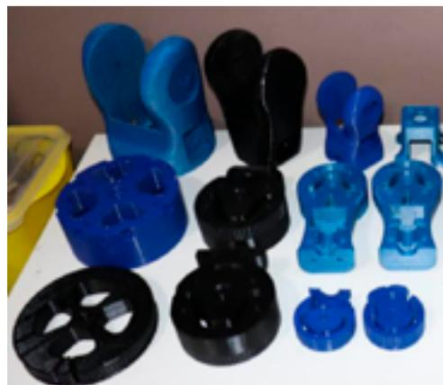
Figura 3: Peças da estrutura física do robô.
