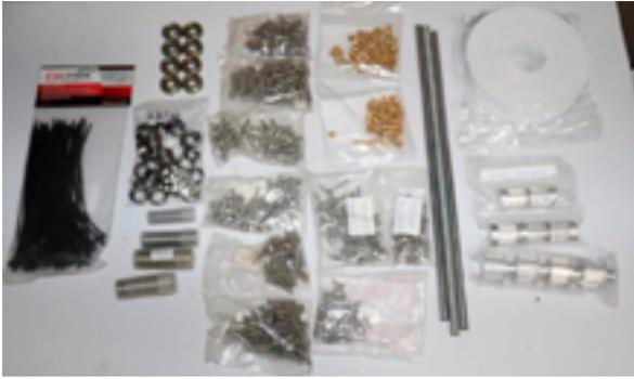
Figura 4: Componentes de conexão mecânica
