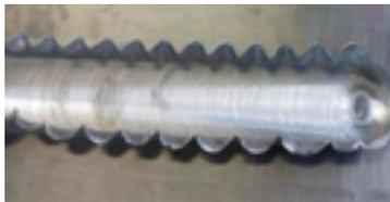
**Figura 4.** Formação excessiva de rebarbas.
