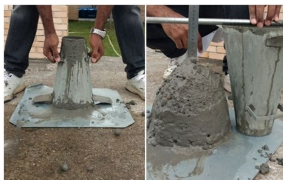
Figura 1 - Ensaio de abatimento do tronco de cone.
