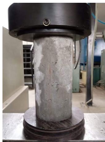
Figura 4 - Ensaio de resistência à compressão axial
