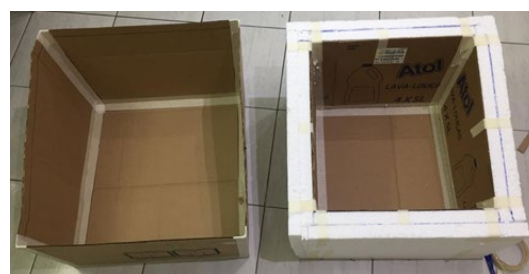
Figura 11 - Caixa externa e a caixa interna com isolamento de isopor Fonte: Autor
