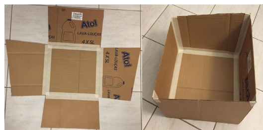
Figura 10 - Fabricação da caixa interna Fonte: Autor
