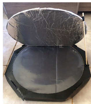
Figura 8 - Parte externa: pasta plástica, refletor com papel alumínio e palito como suporte. Fonte: Autor
