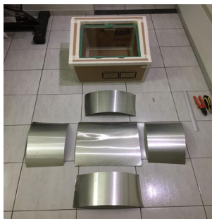
Figura 13 - Chapas de Alumínio cortadas do tamanho da caixa interna. Fonte: Autor
