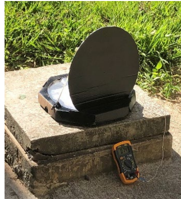
Figura 14 - Medição de temperatura do fogão de pizza. Fonte: Autor
