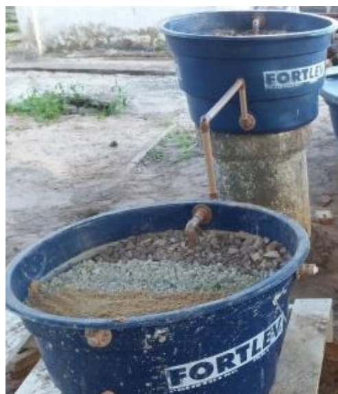
Figura 1 - Disposição do meio filtrante nas caixas d'água.
