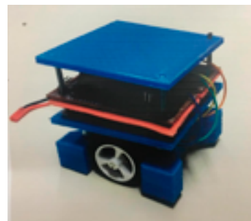
Figura 5- Primeiro protótipo do time de futebol de robôs de baixo custo.
