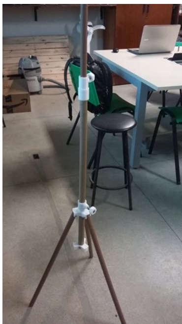
Imagem 3 - Tripé de baixo custo desenvolvido em PVC e peças em PLA.
