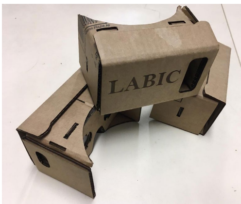
Imagem 4 - Google Cardboards desenvolvidos em cortadora CNC laser.
