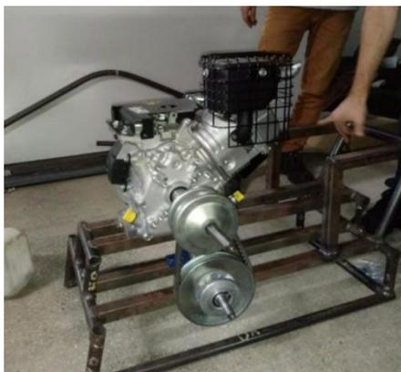
**Figura 05** - Sistema de bancada projetada e fabricada
