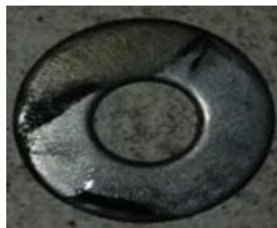
Figura 3 - Corrosão na arruela do sistema estático em água destilada após quatro semanas.
