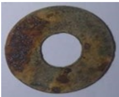
Figura 4 - Corrosão na arruela do sistema dinâmico em solução salina a 5% após quatro semanas
