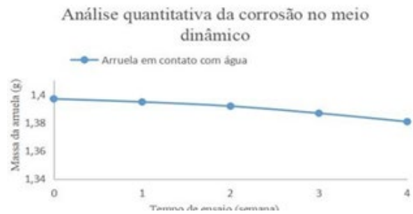
Gráfico 2 - Análise da perda de massa da arruela no sistema dinâmico em contato com água.
