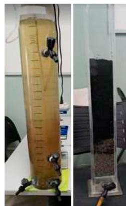
Figura 2 – Reator Aeróbio e Filtro
