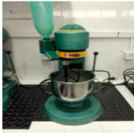
**Figura 1:** Argamassadeira para mistura das matérias primas
