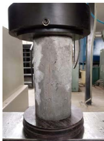
Figura 4 - Ensaio de resistência à compressão axial
