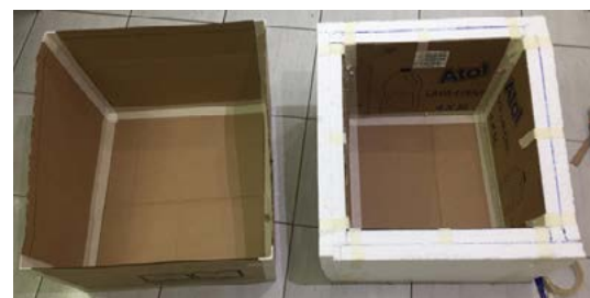
Figura 11 - Caixa externa e a caixa interna com isolamento de isopor Fonte: Autor
