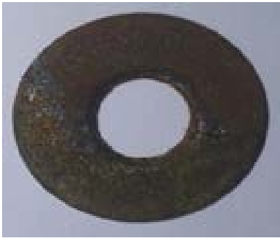
Figura 5 - Corrosão na arruela do sistema dinâmico em água destilada após quatro semanas.
