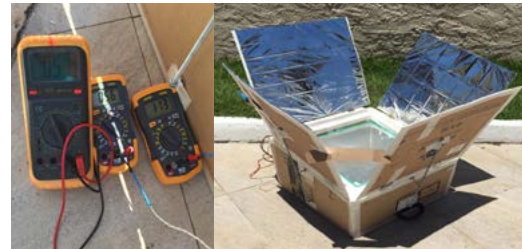
Figura 15 - Medição de Temperatura do Segundo Fogão: Resistência do LDR e Temperatura Externa e Interna
