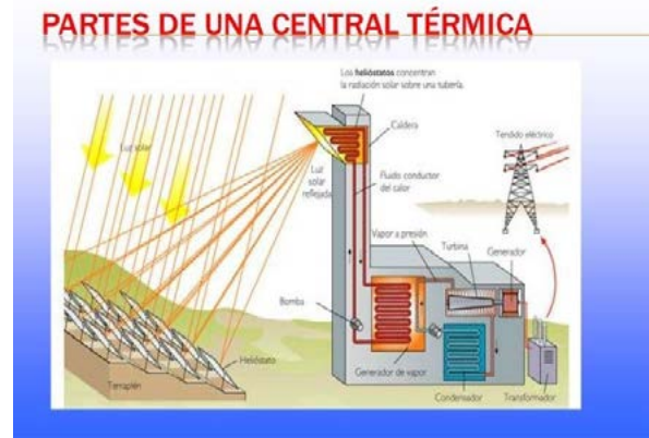
Figura 5 – Ilustração de um sistema de geração de energia elétrica por energia térmica solar [4].
