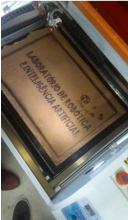
Figura 5 - Corte e marcação utilizando a cortadora a laser
