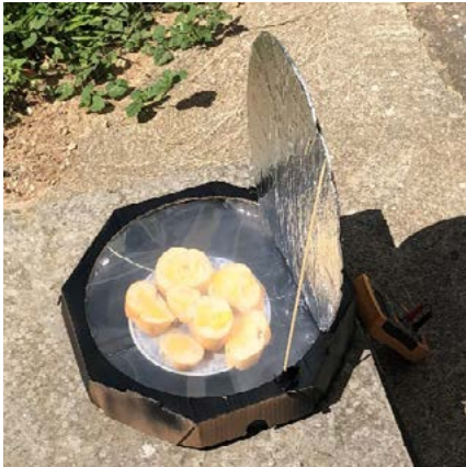
Figura 6 - Primeiro Fogão Tipo Caixa (Caixa de Pizza). Fonte: Autor
