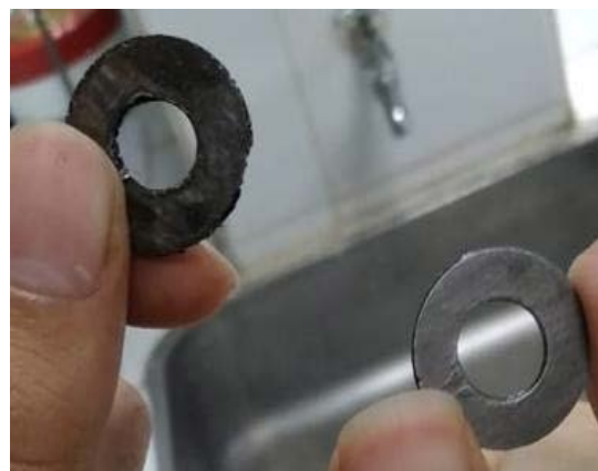
Figura 4 - Arruelas do sistema fechado de ácido muriático (a esquerda) e do sistema aberto (a direita).
