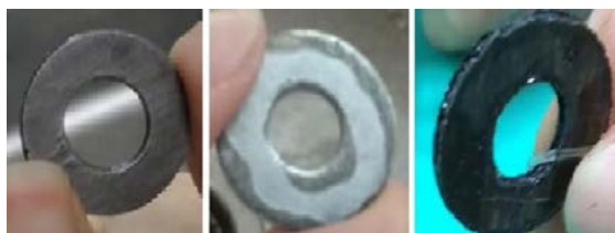
Figura 1 - Arruelas em seu estado corroído ao fim de uma semana: (a) Sistema 1; (b) Sistema 2; (c) Sistema 3.
