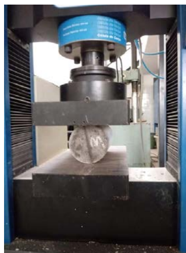
Figura 5 - Ensaio de resistência à tração por compressão diametral
