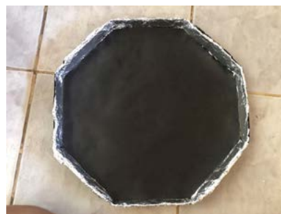
Figura 7 - Parte interna do fogão: revestimento de alumínio e papel preto Fonte: Autor
