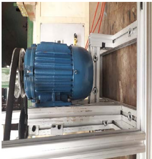
Figura 4 - Suporte do motor com polia acoplada ao eixo.
