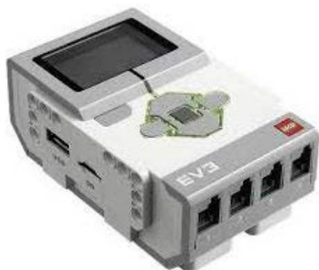
Figura 4 - Bloco programável Brick.
