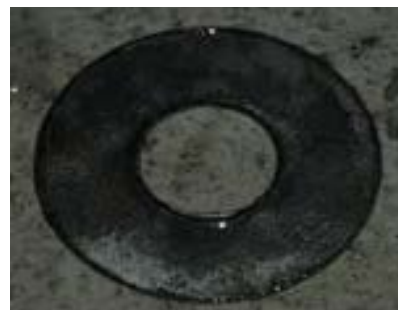
Figura 4 - Corrosão na arruela do sistema estático em solução salina a 5% após quatro semanas.
