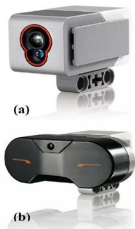
Figura 3 - Sensores básicos para um Robô de Resgate. a) Sensor de cor. b) Sensor infravermelho.
