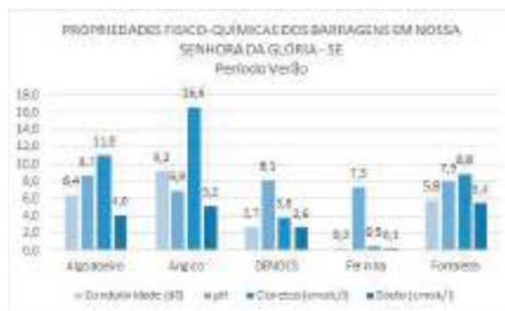
Figura 1 – Parâmetros Condutividade Elétrica (CE) em dS/m, pH e Sódios em cmolc/l, das barragens Algodoeiro, Angico, Denocs, Feirinha e Fortaleza, analisados no Verão, no Município de Nossa Senhora da Glória - Sergipe(2018-2019).
