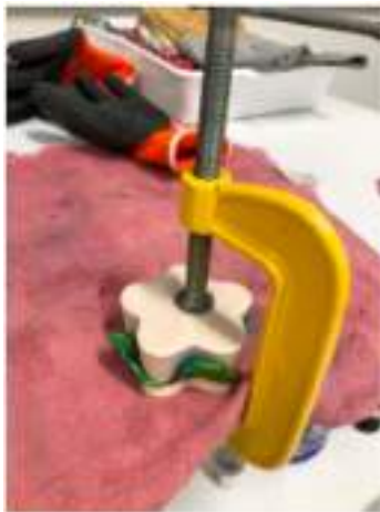
Figura 4 – Material derretido sendo prensado com auxílio de sargentos. Fonte: Autores, 2020.
