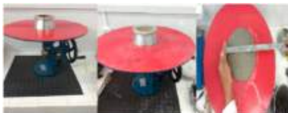
Figura 2: Ensaio de Índice de consistência da argamassa no estado fresco
