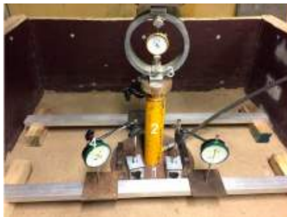
Figura 1: Equipamentos e instrumentação utilizados no ensaio: (1) Placa metálica, (2) Macaco hidráulico, (3) Anel de carga e (4) Relógio comparador.
