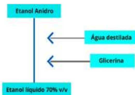
Fluxograma 5: Produção do álcool líquido glicerinado 70% v/v
