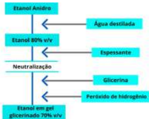
Fluxograma 3: Produção do álcool gel glicerinado 70% v/v
