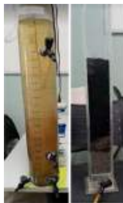
Figura 2 – Reator Aeróbio e Filtro
