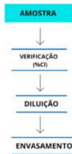
Fluxograma 1: Produção da água sanitária
