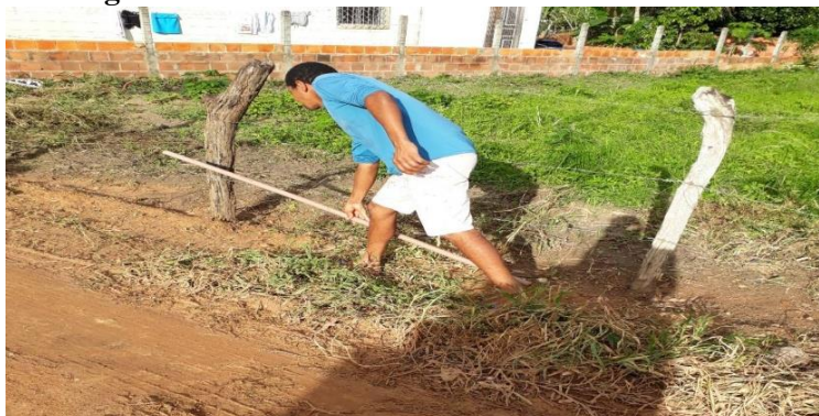
Figura 2 - Cubador medindo um terreno com a vara.
